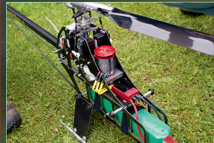
Das Siegermodell von Jan Henseleit sieht eigentlich ganz normal aus. Das Innenleben des Pyro hat allerdings nichts mehr mit der Serie zu tun. Ein Bekannter von Jan legte hier Hand an, um die Leistung des Motors zu steigern.
