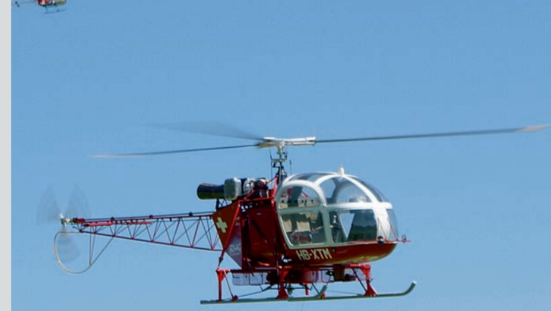
Michael Wöhrmann's Lama wurde auf Basis des VARIO-Rumpfs gebaut. Mechanik, Drei-blatt-Rotorkopf und Heckrotor hat er jedoch zusammen mit seinem Vater Heiner selbst gebaut. Sein Modell bringt 21 kg auf die Waage – allerdings vollgetankt. Auch er vertraut auf eine Jakadofsky Pro Edition Turbine.
