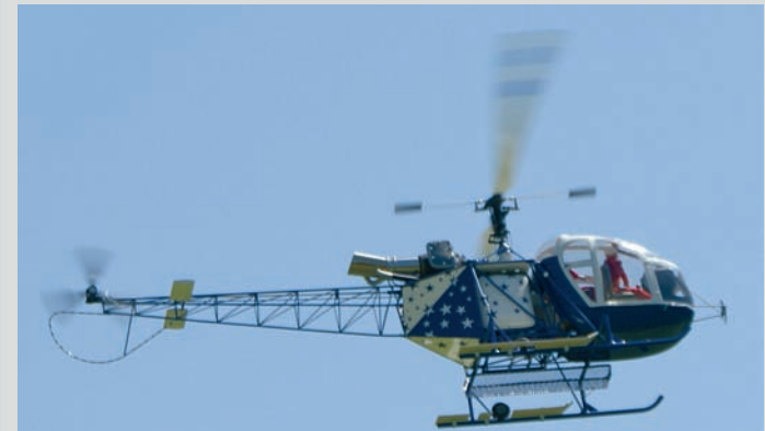
Die Lama von Gerd Anderheiden aus Krefeld entstammt einem VARIO-Bausatz, hat einen Rotordurchmesser von 2,50m. Die Turbine vom Typ Jakadofsky Pro Edition hatte leichtes Spiel mit dem unbetankt 21 kg schweren Modell.
